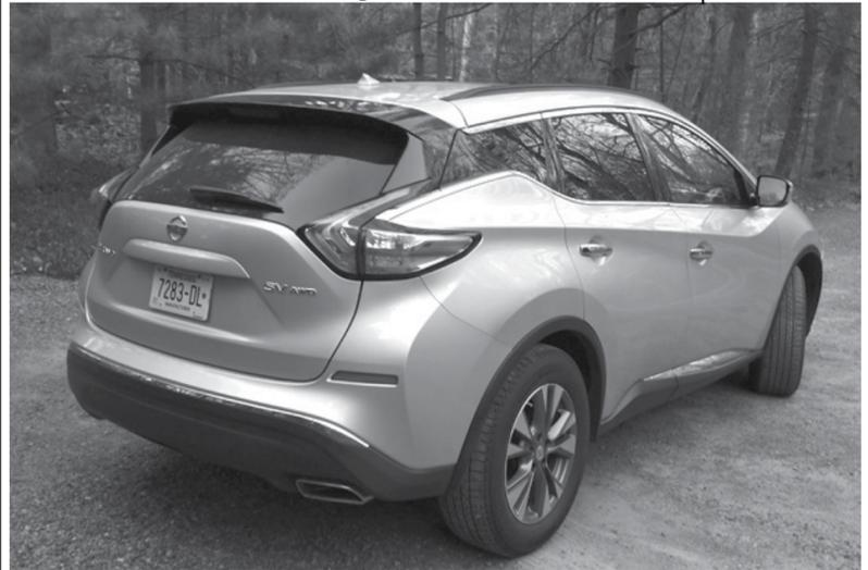
Está fabricado en la planta de Mississippi y llegó con un motor 3.5 V6 gasolina de 260 cv asociado al cambio automático (CVT) y a un sistema de tracción integral.
